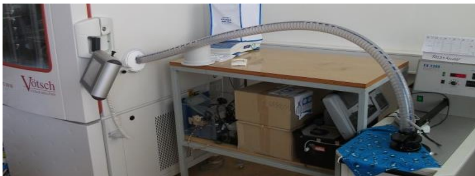
Şekil 1. Sıcak ve nemli hava kaynağı VOETSCH, hava geçirgenliği test cihazı FX 3300, hava sıcaklığı ve nem ölçümü yapan AHLBORN' dan oluşan ölçüm düzeneği
