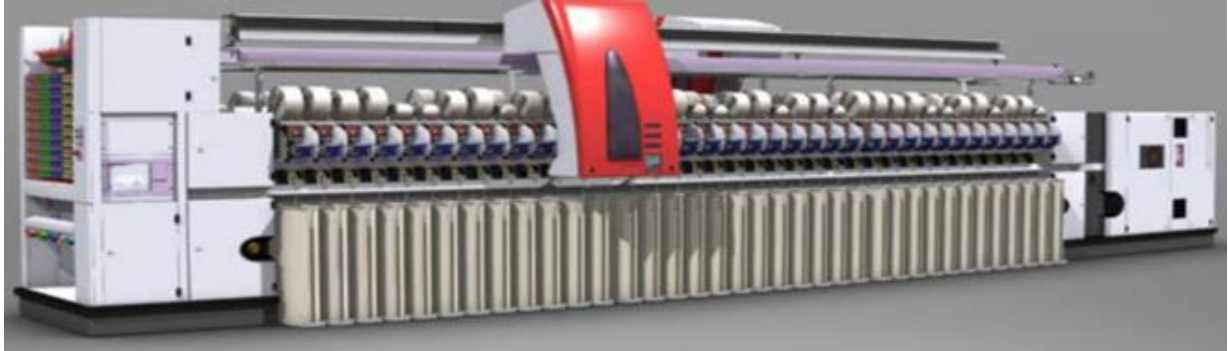
Şekil 1. Her eğirme ünitesi bağımsız kontrol edilen Autocoro 8 Open End makinesi
