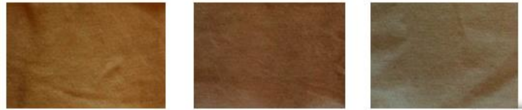
Şekil 2. Çam kabuğu BM ile şap, bakır sülfat ve demir sülfat kullanılarak boyanmış numuneler
