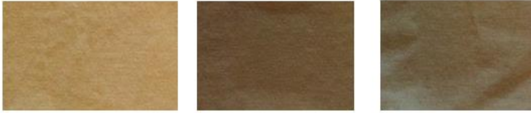
Şekil 1. Ceviz kabuğu BM ile şap, bakır sülfat ve demir sülfat kullanılarak boyanmış numuneler
